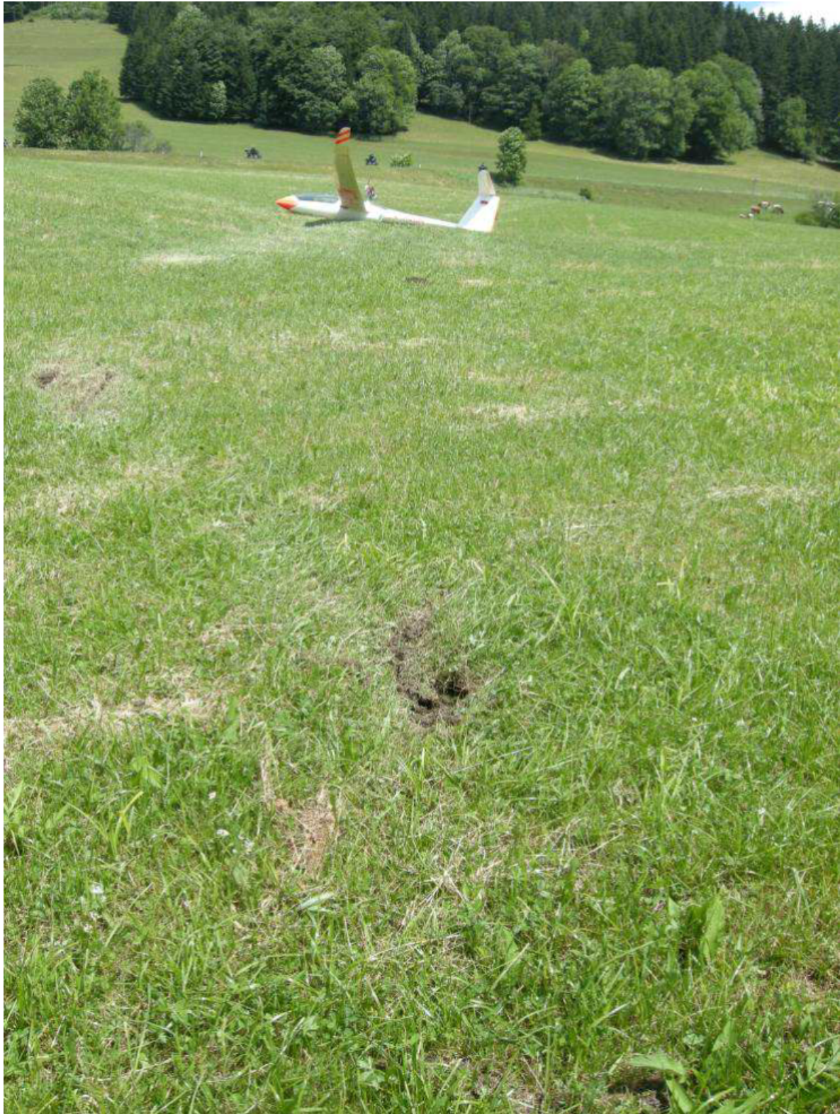
Abbildung 10 Endlage des Motorseglers am Unfallort in Anflugrichtung (Osten) betrachtet, im Vordergrund Spuren des Aufpralls in der Wiese
