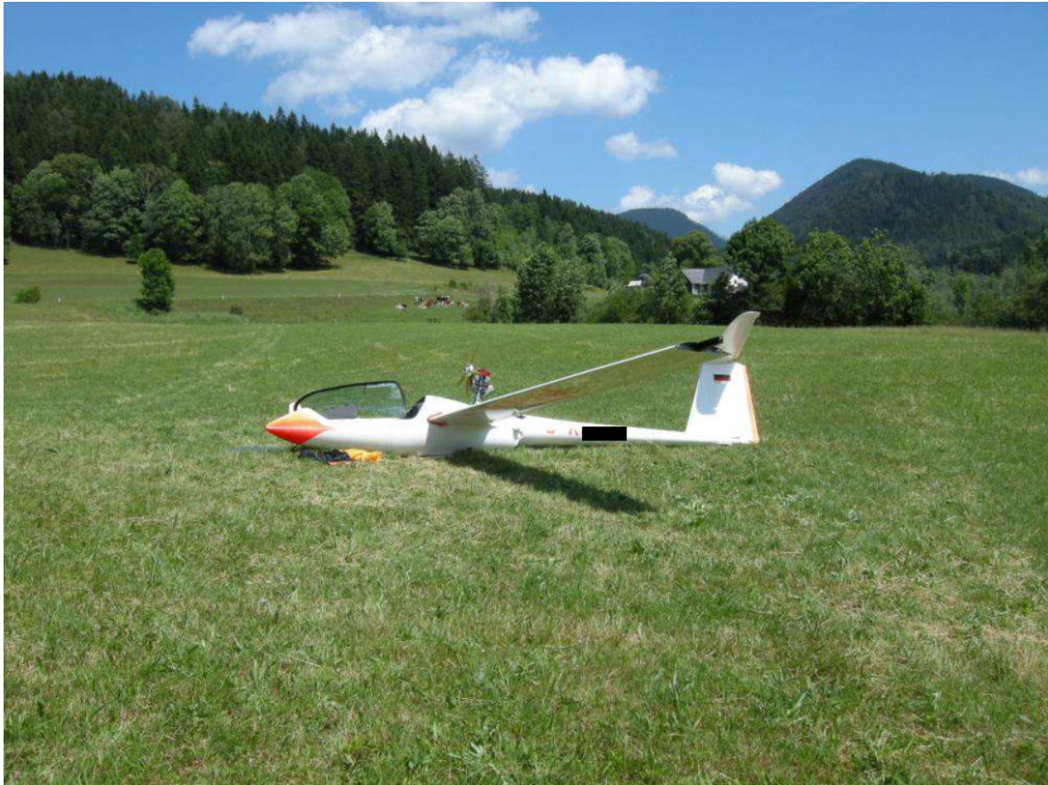
Abbildung 1 Endlage des Motorseglers quer zur Landerichtung (linker Ansteckflügel mit Winglet zur Bergung demontiert)
