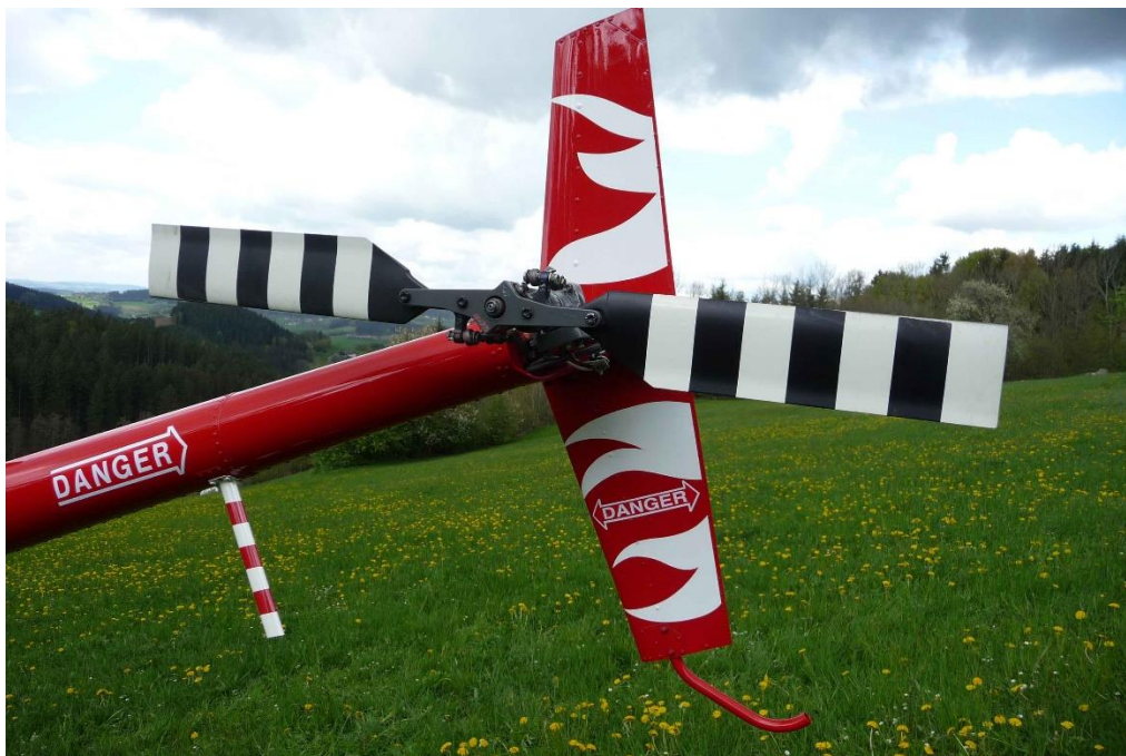
Abbildung 5 Detailaufnahme der vertikalen Stabilisierungsflosse mit Heckrotor
